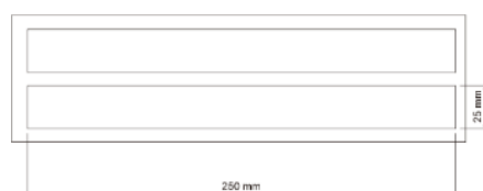
Gambar 2. Desain Cetakan Spesimen Blok Rem Komposit Kereta Api
