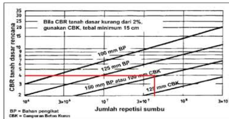
Gambar 3. Tebal Fondasi Bawah Minimum
