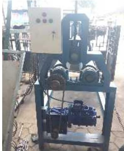
Gambar 4. Mesin Roll Pelat Dengan Kontrol
