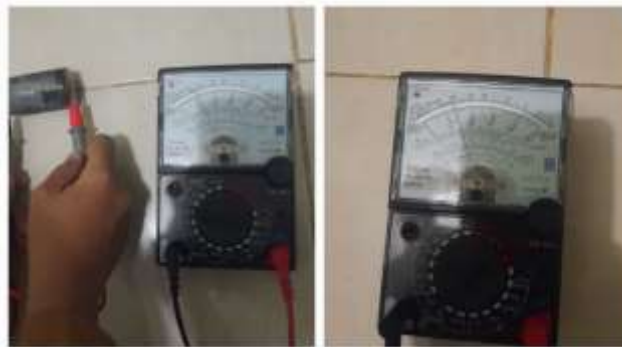
Gambar 3 Hasil pengukuran variasi ke-2 dengan multimeter analog (a) tegangan; (b) arus
