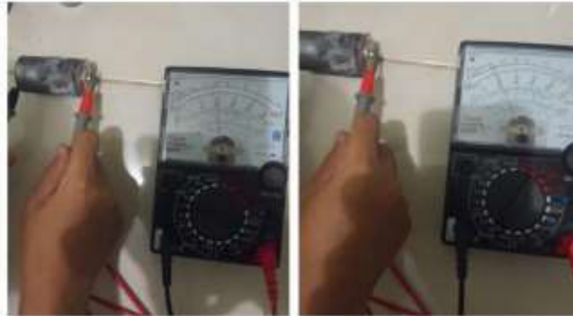
Gambar 2 Hasil pengukuran variasi ke-1 dengan multimeter analog (a) tegangan; (b) arus
