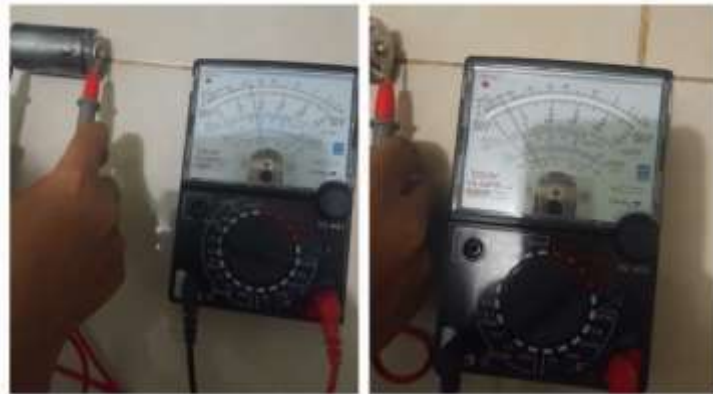
(a) (b) Gambar 7 Hasil pengukuran biobaterai dari kulit durian tanpa campuran elektrolit dengan menggunakan multimeter analog (a) tegangan; (b) arus
