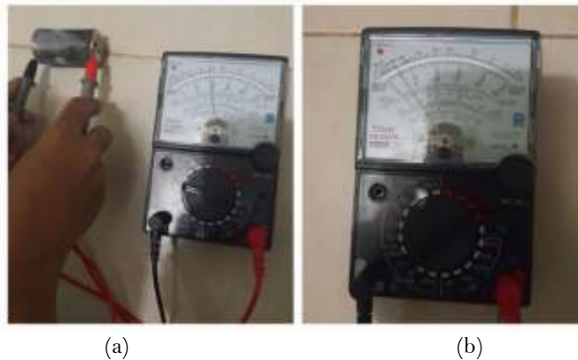
Gambar 6 Hasil pengukuran variasi ke-5 dengan multimeter analog (a) tegangan; (b) arus
