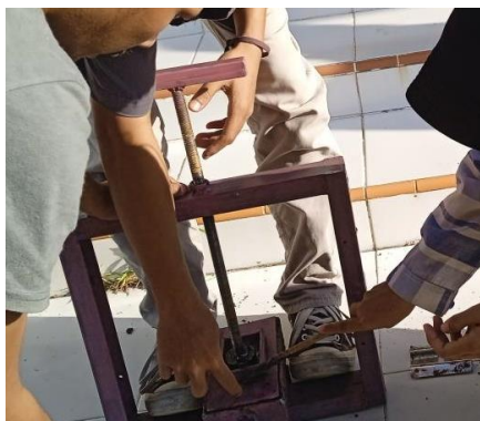
Gambar 3. Posisi cetakan paving setelah semua adonan dituang
