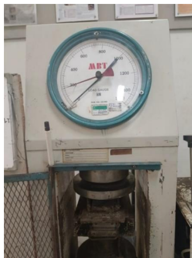
Gambar 4. Proses Pengujian Tekan dengan Mesin UTM
