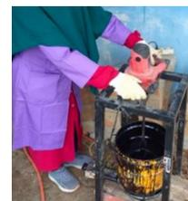
**Gambar 4** Proses Pencampuran Aspal dan Karet
