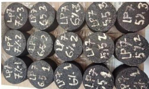
**Gambar 8.** Bentuk Sampel Marshall LP7%
