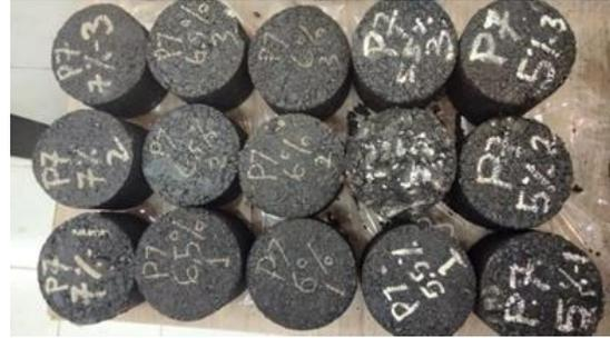
**Gambar 7** Bentuk Sampel Marshall P7%
