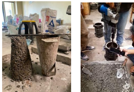
Gambar 3. Uji Slump dan Proses Pemadatan
