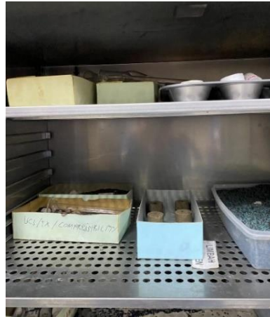
Gambar 19. Pengeringan Sample core menggunakan Conventional Oven
