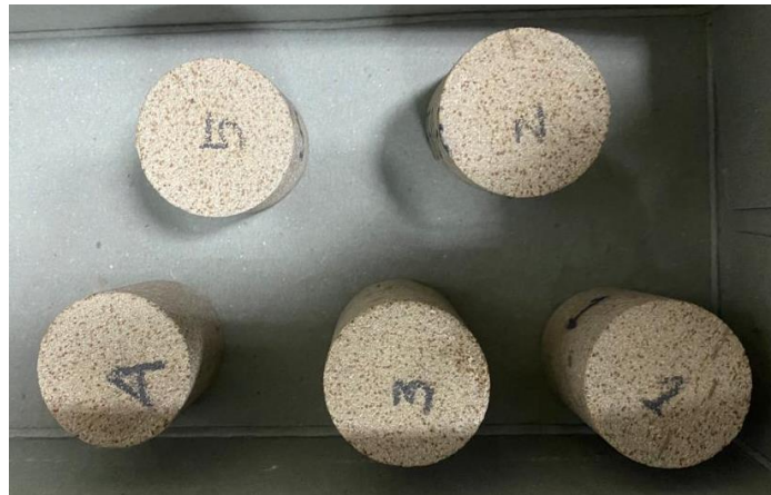
Gambar 18. Hasil Pemotongan Sample core menggunakan Core Trimmer
