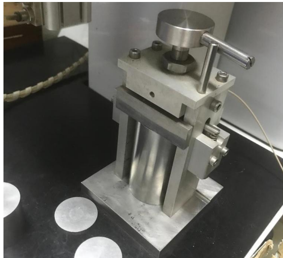
Gambar 22. Sample dimasukkan ke dalam Core Holder Alat Coreval 700
