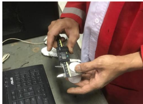
Gambar 20. Pengukuran Diameter dan Panjang Sample core menggunakan Jangka Sorong
