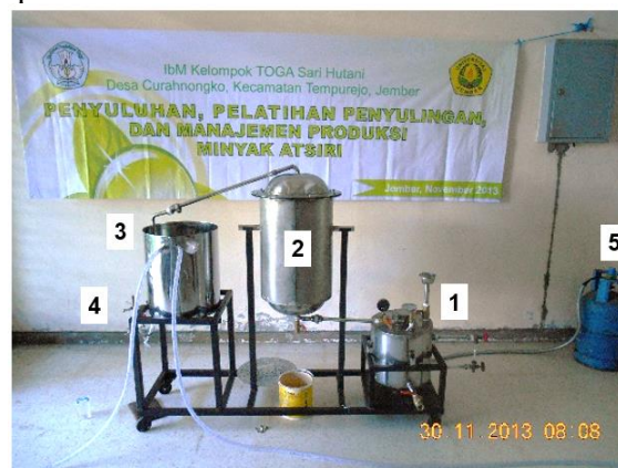
Gambar 3. Set up alat penyulingan minyak atsiri untuk kelompok TOGA Sari Hutani. Keterangan: (1) boiler; (2) ketel suling; (3) kondensor; (4) kran distilat; (5) tabung gas.
