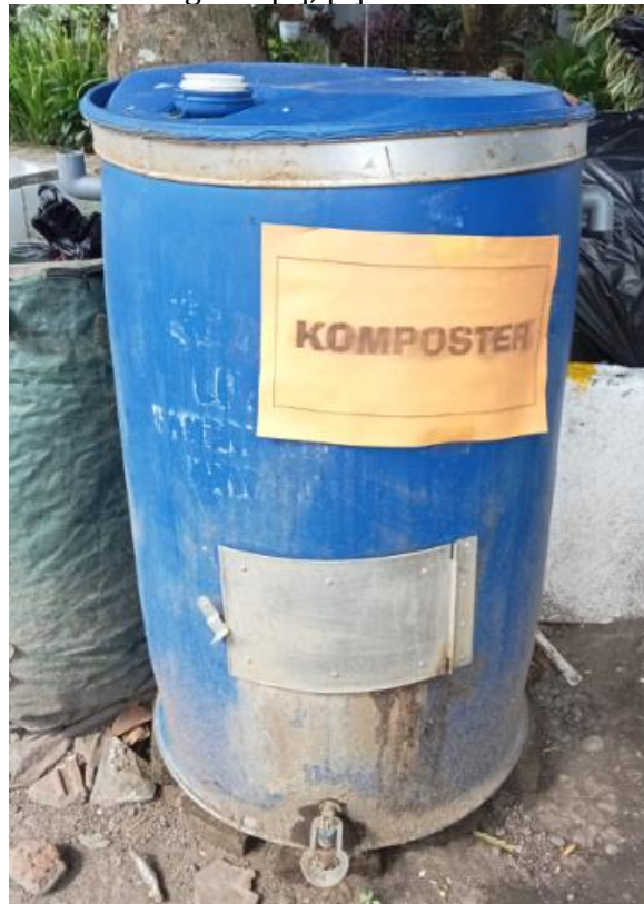
Gambar 7. Kondisi komposter yang digunakan sejak bulan Agustus 2022 sampai 2024. Secara umum masih berfungsi baik namun membutuhkan beberapa tindakan untuk kebersihan dan pengecekan kran buangan limbah cair.
