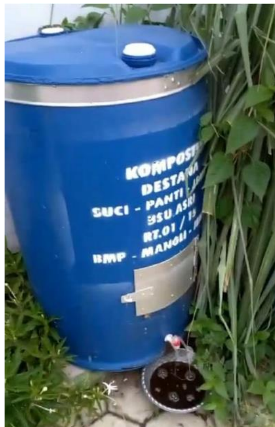
Gambar 2. Komposter yang telah di pasang dan mulai bekerja di indikasikan produksi limbah cair hasil proses dekomposisi sebagai pupuk organik cair (POK)
